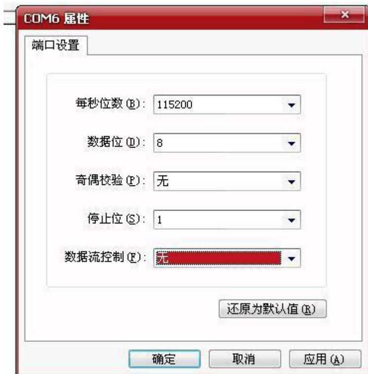
图 1.4.21 端口的属性设置
